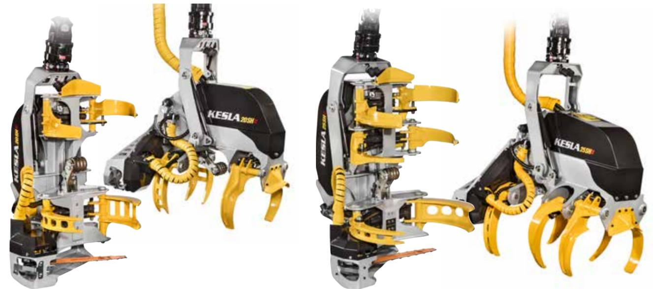
El KESLA 20SH-II está equipado con dos cuchillas de desrame móviles. Es un cabezal cosechador ligero pero altamente eficiente para maderas nobles y otros árboles muy ramosos. Está indicado para su instalación en excavadoras de orugas de 7-10 toneladas y otras máquinas de base con potencia hidráulica limitada, como las arrastradoras.
