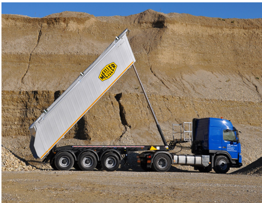
Fabricado para aplicaciones de volcado difíciles: transporte de material suelto en la logística de construcción para empresas de transporte y transportistas.
