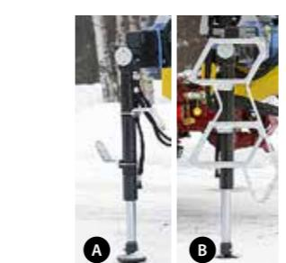
Las escaleras resistentes y bien diseñadas de los apoyos aportan más seguridad al trabajo. A: Escalera de serie; B: Escalera confort
