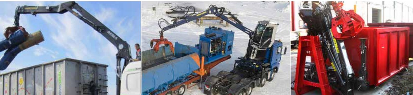
La totalidad de la amplia gama de grúas KESLA se puede equipar para la manipulación de variados tipos de materiales de reciclaje. En los sistemas de control existen dos niveles de equipamiento: un sistema completamente electrónico con radiocontrol y un conjunto de control mecánico y por radio. En ambas alternativas se han tomado en consideración las disposiciones en materias de seguridad de las directivas de la UE.
