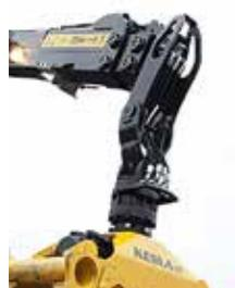
La conexión KesLINK, en cuyo interior quedan bien protegidos los conductos del dispositivo de giro y la garra.
