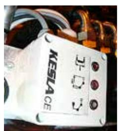
Equipamiento KESLA con distintivo CE, sistema de supervisión de carga y posición de transporte conforme a las directivas de la UE.
