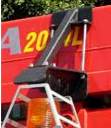
Se puede colocar un tope de apoyo que facilita la manipulación de los troncos enteros en el brazo de elevación y, dependiendo del modelo de grúa, también en el brazo de transferencia.
