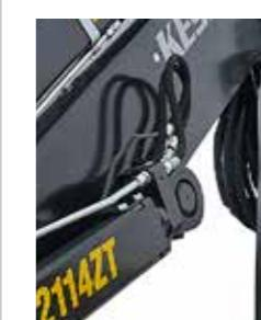
Válvulas de cálculo de carga integradas en los cilindros de elevación y ajuste, sin partes externas expuestas a fractura (serie 21).
