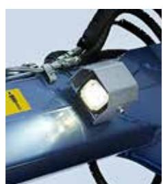
Eficaz iluminación de trabajo correctamente situada y bien protegida, con luces de xenón H3 o LED.
