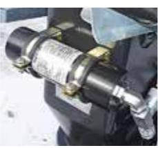
Amortiguador por acumulador de presión según la elección para el cilindro de giro, de elevación y de ajuste
