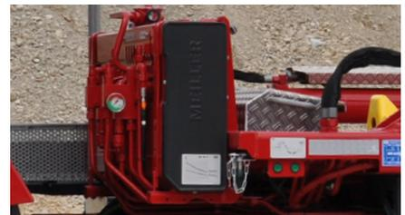
Unidad de mando MEILLER con indicador de control de sobrecarga integrado (serie con equipo telescópico)
